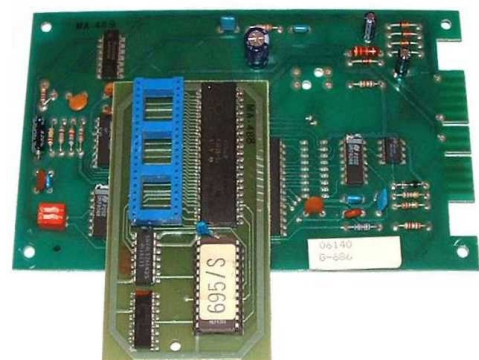
Typ 4 Soundplatine Die grösste und komplizierteste, mit zwei Sound-speicherkarten.
