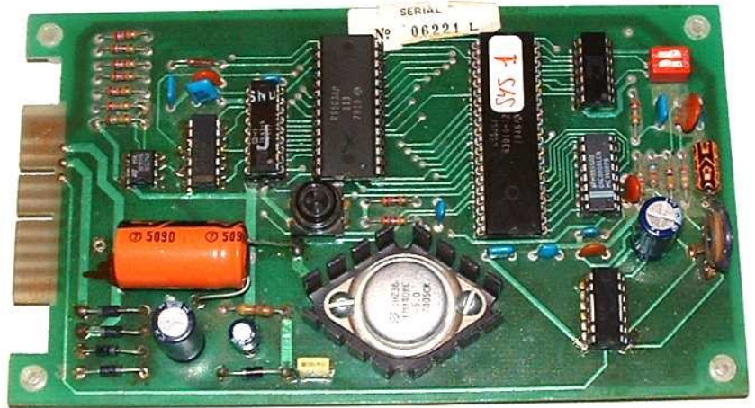
Typ 2 Soundplatine Kmplzierter, mit Mikroprozessor und Sound-Speicherkarte in dessen die Nummer des Spiels gebrannt ist.
