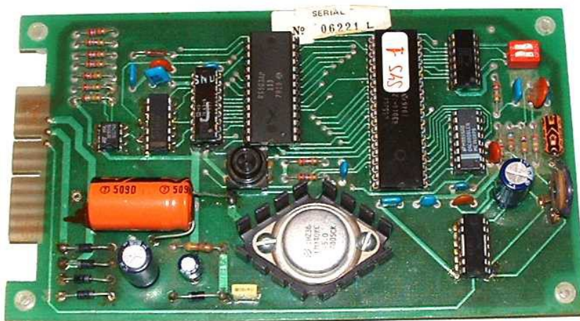
Type 2 geluidskaart Complexer, door microprocessor aangestuurd en gebruikt een specifieke geheugenchip met letter van het spel erop.
