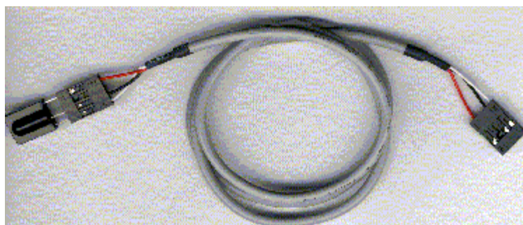
Capteur -- Câble 2 conducteurs + masse -- Vers Connecteur U6
